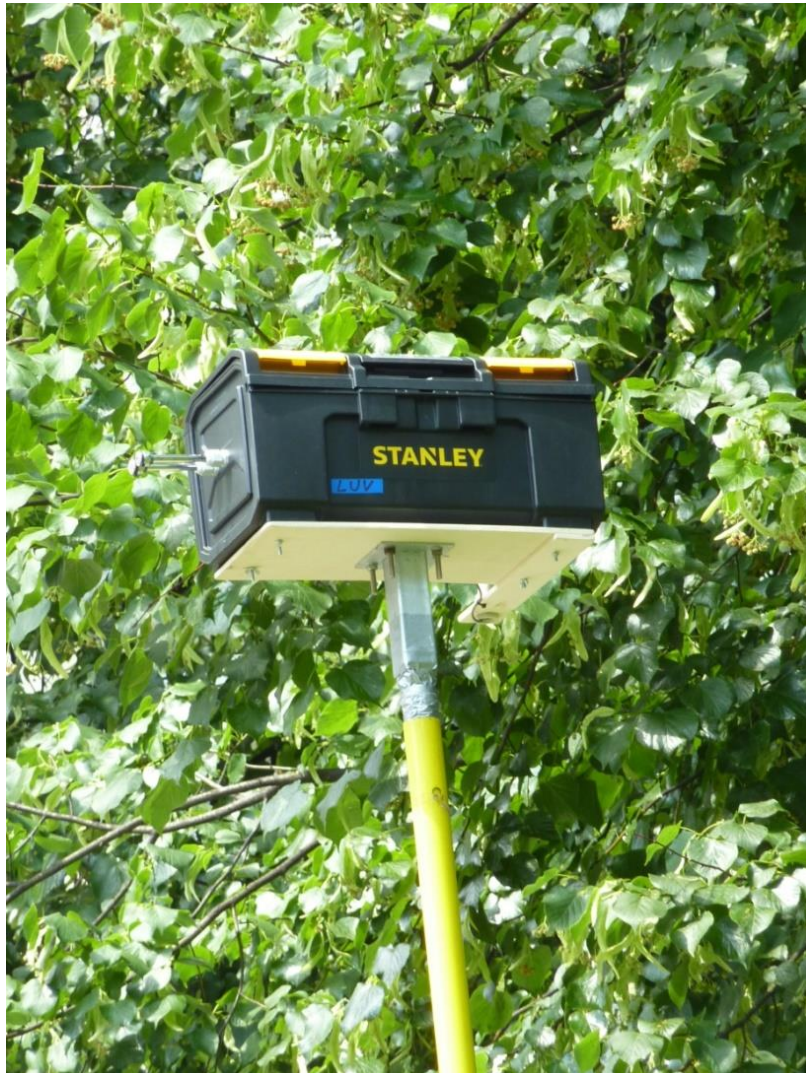
Abbildung 55. Feinstaub Messung in direkter Nähe zum Baum (hier auf Luv Seite, vor dem Baum)
