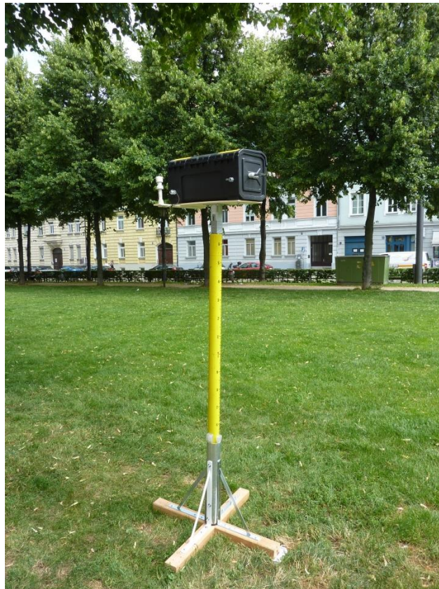
Abbildung 54. Mess-set in Werkzeugkasten auf Teleskopstab
