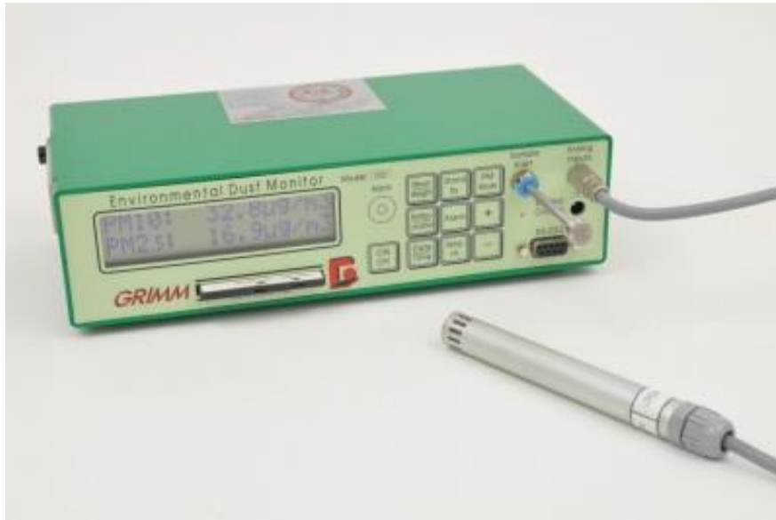
Abbildung 52. Environmental Dust Monitor (Model: Grimm 107) (Grimm Aerosol Technik GmbH, 2008)
